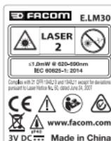
A ferramenta FACOM E.LM30 emite um raio laser visível, conforme apresentado na Figura A. O raio laser emitido pertence à Classe de laser 2 conforme a norma IEC 60825-1 e cumpre as regras 21 CFR 1040.10 e 1040.11, à exceção das alterações realizadas no seguimento da Laser Notice n.º 50, com data de 24 de junho de 2007.
