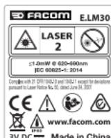
La herramienta FACOM E.LM30 emite un rayo láser visible, tal y como se muestra en la figura A. El rayo láser emitido es un láser de clase 2 según IEC 60825-1 y cumple con 21 CFR 1040.10 y 1040.11, con excepción de las desviaciones, de conformidad con la notificación Laser Notice N° 50 del 24 de junio de 2007.
