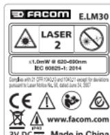
Het FACOM E.LM30-instrument produceert een zichtbare laserstraal, zoals weergegeven in Afbeelding A. De geproduceerde laserstraal is van Laserklasse 2 volgens IEC 60825-1 en is in overeenstemming met 21 CFR 1040.10 en 1040.11, met uitzondering van afwijkingen conform lasernotificatie nr. 50, van 24 juni 2007.
